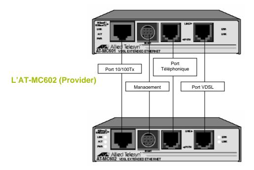
Les AT-MC600 sont des équipements Transparents Ethernet, Transparents aux paquets VLAN Tag supportant des liaisons voix analogiques ou numérique.
