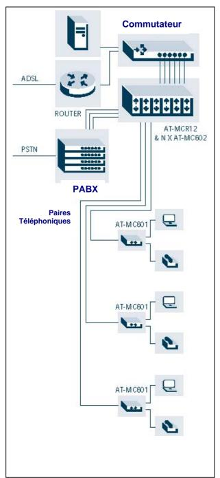
Cet exemple montre le déploiement d'un site ou les stations de travail sont connectées au réseau de l'entreprise par l'intermédiaire du câblage téléphonique existant.
